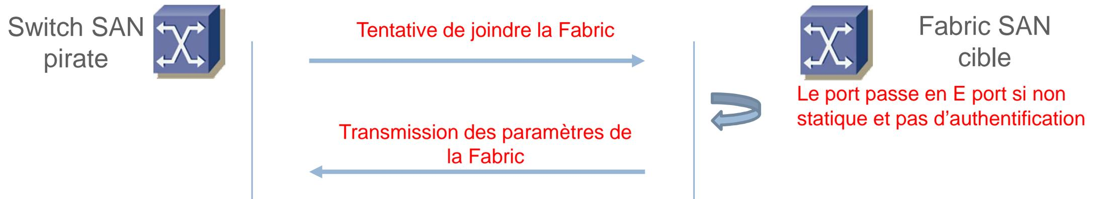
**Un switch accepté par la Fabric a accès à l'intégralité de la configuration et peut la modifier**
